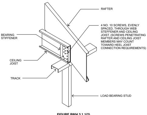
FIGURE R804.3.1.1(2) BEARING STIFFENER
